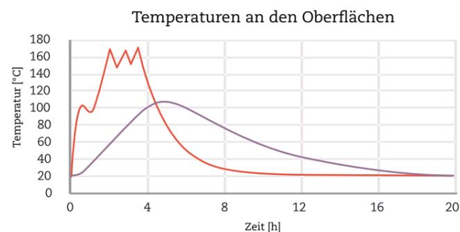
Bei der Deko Due sorgt der Doppelmantel aus Mammutti-Speckstein für gleichmäßige, auch nach Erlöschen der Flamme bis zu 12 Stunden lang anhaltende Komfortwärme.
