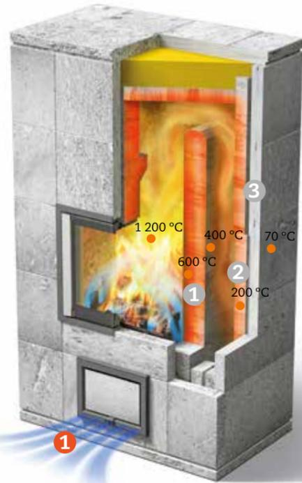
Der Mammutti-Speckstein ist parallel zur Schieferung ein schneller, in der Gegenrichtung ein langsamerer Wärmeleiter. In den Bauteilen der Feuerstätte wird diese Relation von Wärmeleitfähigkeit und Schieferung ausgenutzt, um eine optimale Wärmeabgabe zu erzielen.
