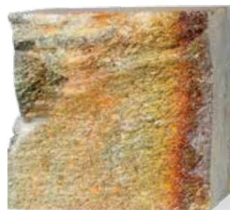
Die abgebildete Oberfläche des Feuerraumsteins hat sich im Betrieb hellbraun verfärbt. Bei einer Temperatur von 520°C wird das im Speckstein enthaltene Magnesit (MgO) an der Oberfläche zu Periklas. Der so entstehende Periklas und der Talk des Specksteins versintern zur
